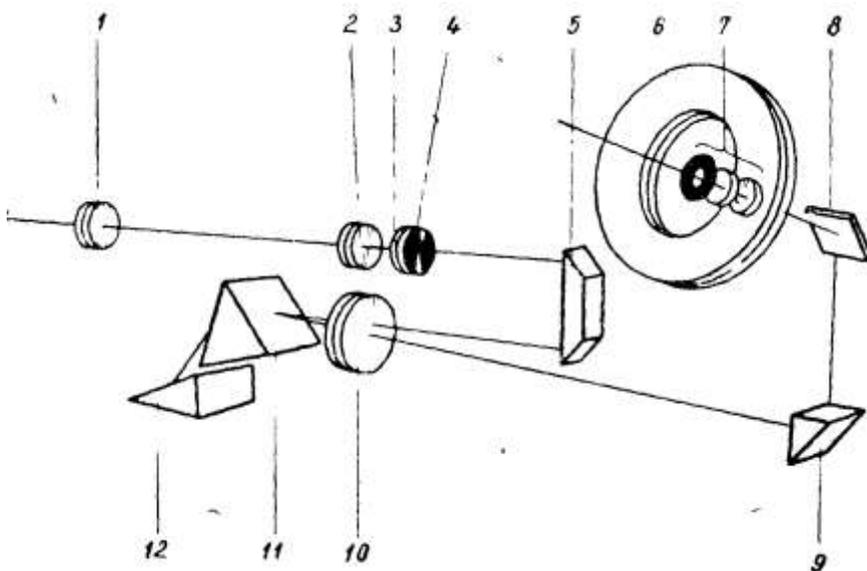
Рис. 1. Оптическая схема стилоскопа
