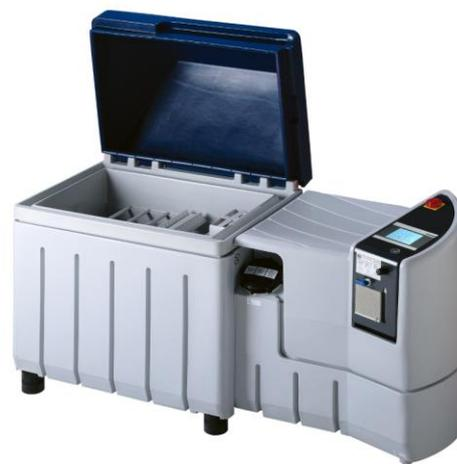
В верхней части камеры, по всему периметру торца контейнера выполнен канал, заполняемый водой для обеспечения гидростатического уплотнения соединения крышка-контейнер во время испытания. Это исключает утечку соляного тумана из зоны испытаний. На правой стороне контейнера, канал выполнен шире и глубже для возможности прокладки измерительных и технологических кабелей. Таким образом, возможно подключить испытуемый образец к внешней системе измерения и сбора данных.
