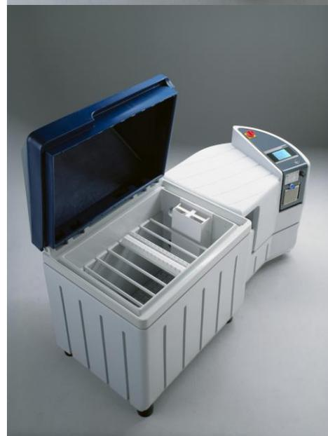
Соляной раствор, образующийся в результате конденсации тумана на стенках контейнера, отводится из зоны испытаний через дренажное отверстие в полу контейнера. Избыток соляного тумана, за счет перепада давления, отводится из камеры в систему вентиляции рабочего места и далее в окружающую атмосферу. Для проведения испытаний, в контейнер камеры не требуется устанавливать какое-либо вспомогательное оборудование, что позволяет максимально использовать объем испытательной зоны.
