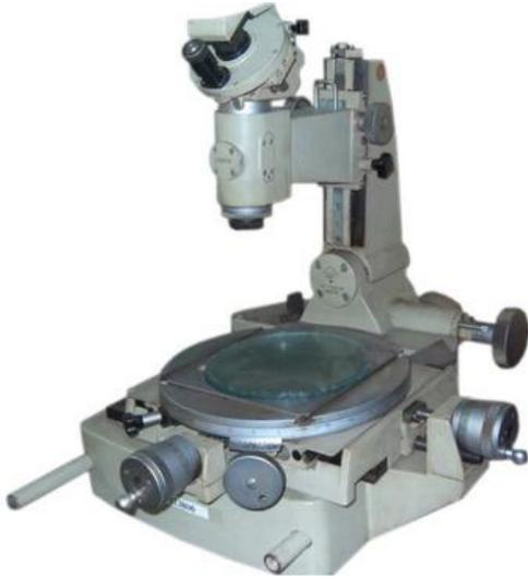
Микроскоп инструментальный БМИ-1 предназначен для измерения:
