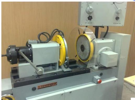
Машина 2168 УМТ предназначена для испытания различных фрикционных и смазочных материалов на трение и износ в широком диапазоне нагрузок, скоростей и схем испытаний.
