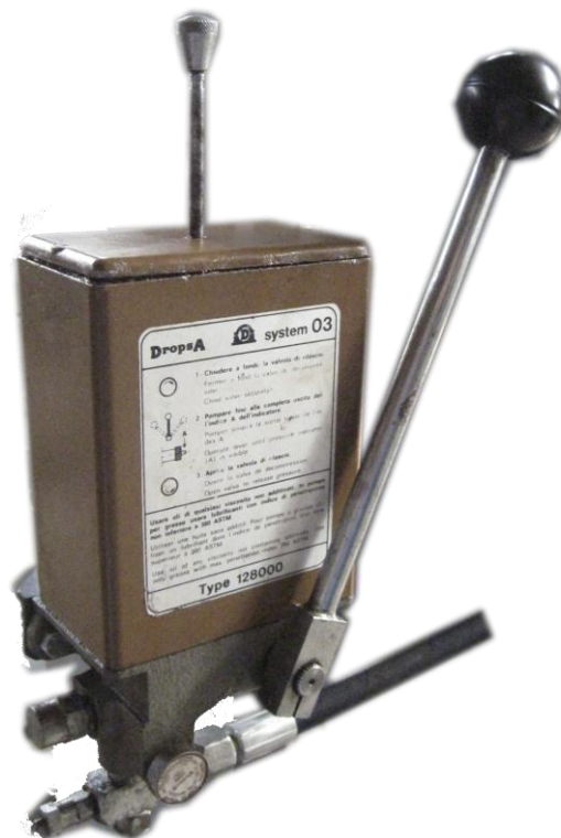
Рис. 17 – Ручний насос для змащування направляючих повзуна
