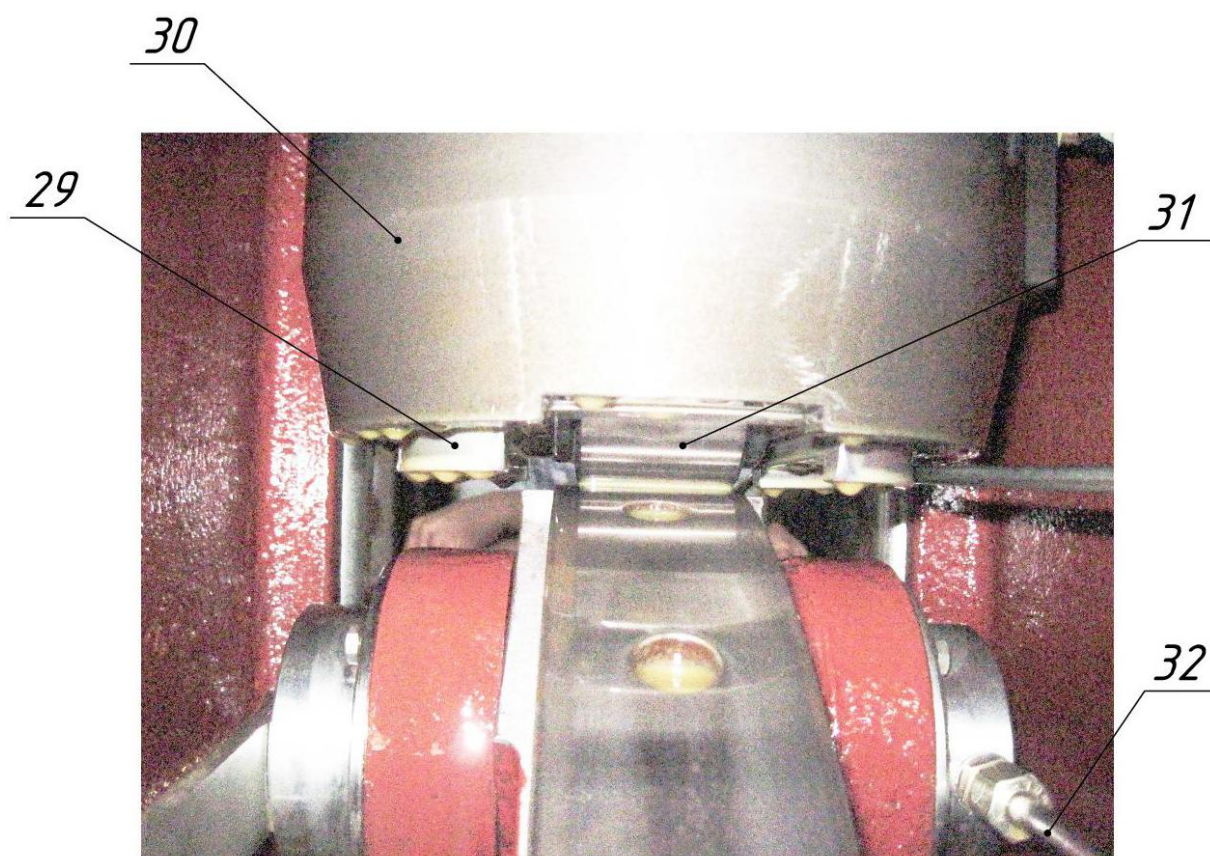
Рисунок 5 – Картер пульсатора. Привід поршня
