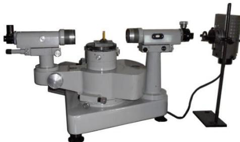
Гониометр Г-5 предназначен для измерения углов между нормалями к плоским полированным граням твердых прозрачных и непрозрачных тел и пирамидальности призм. Гониометр Г-5 состоит из автоколлиматора, микроскопа, корпуса, столика с лимбом и осевой системой. Оптическая схема гониометра состоит
