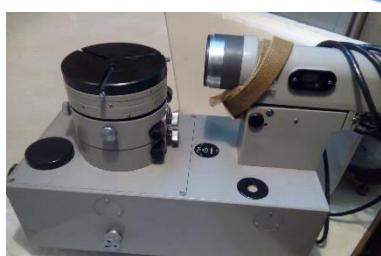
**Гониометр Г5М** представляет собой оптическое устройство лабораторного предназначения, которое рассчитано на выполнение измерений углов, образующихся между плоскими гранями, которые способны отражать световые лучи. При помощи гониометрической системы можно исследовать плоские отполированные грани твердых тел, а также измерять
