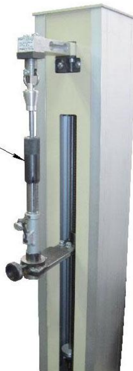
Рис. 4 – Калібрування приладу СВУ на розривній машині
