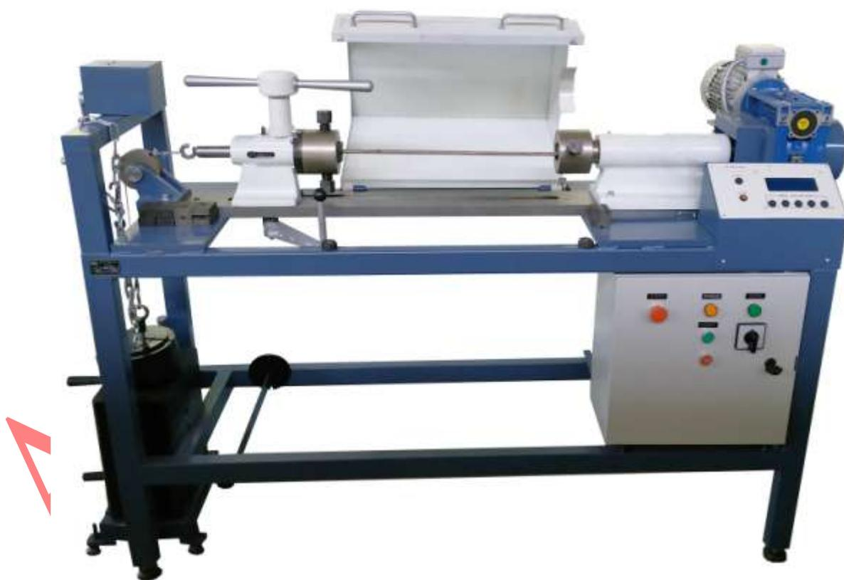
Рис. 1 Общий вид машины на скручивание 2048 МТС
