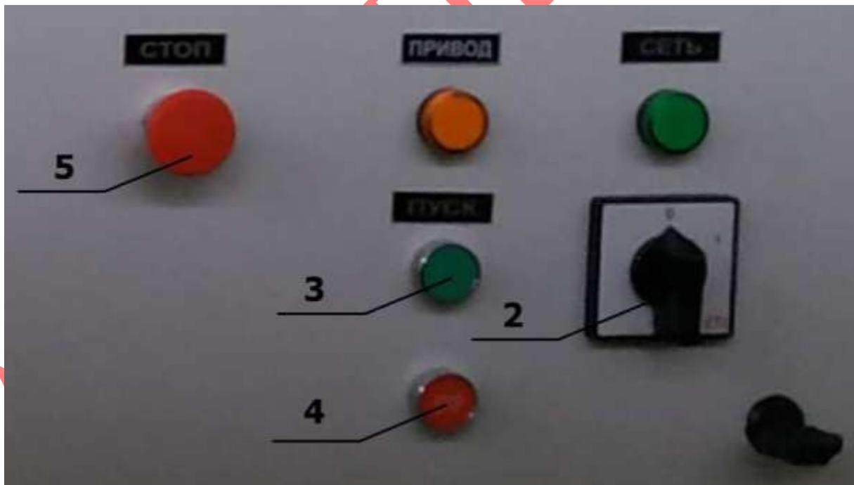
Рис. 2 Панель управления электропитанием машины 2048 МТС
