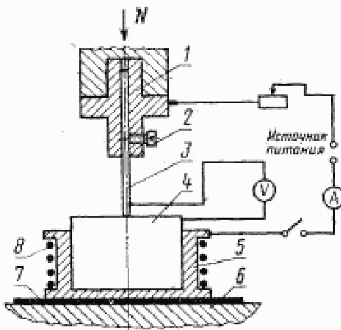
1.2. Испытываемый образец изготавливают из материала контакт — детали по той же технологии, что и реальную деталь. Рабочая поверхность образца должна иметь шероховатость  $Ra \leq 0,16$  мкм по ГОСТ 2789—73.
