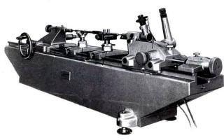
Оптико-механические машины для измерения длин предназначаются для измерений наружных и внутренних размеров мер и изделий по точным линейным шкалам машины методом непосредственной оценки или путем сличения с концевыми мерами (относительным методом). Измерения на машине должны производится в помещении с температурой воздуха от +20 +1° С и относительной влажностью не более 80%.
