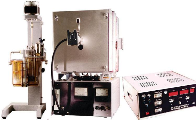
Экспресс-анализаторы на углерод АН-7529.1 и АН-7560.11 предназначены для определения массовой доли углерода в сталях, сплавах и других материалах методом кулонометрического титрования, для маркировочных анализов на углерод продукции и сырья металлургических и металлообрабатывающих предприятий, а также проведения других анализов на углерод в лабораториях предприятий и
