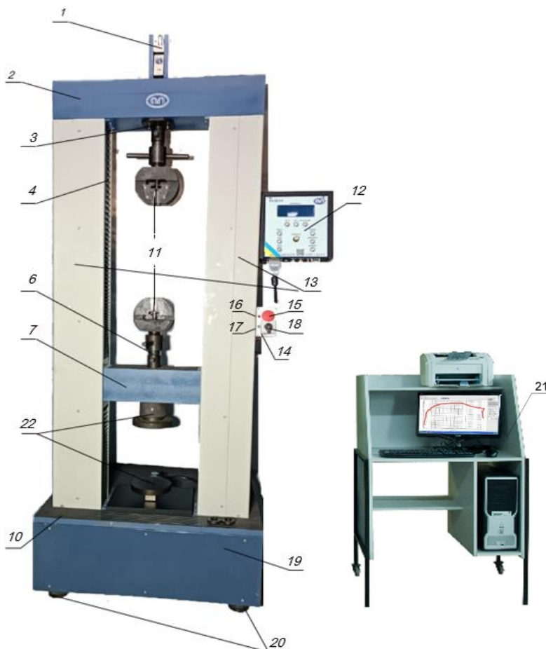
Мал.1 – Загальні вузли (вигляд спереду)
